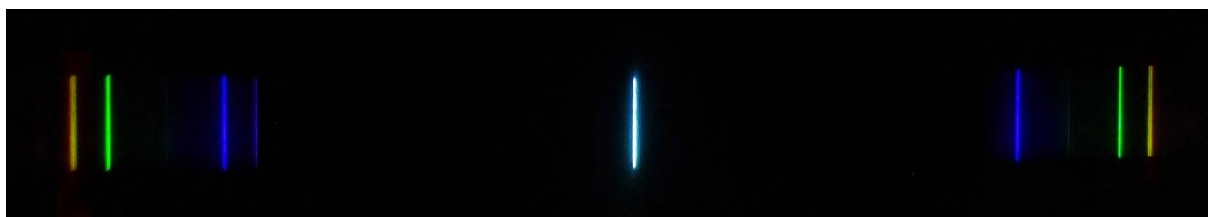
Exemple de spectre observé avec une lampe à vapeur de Mercure
