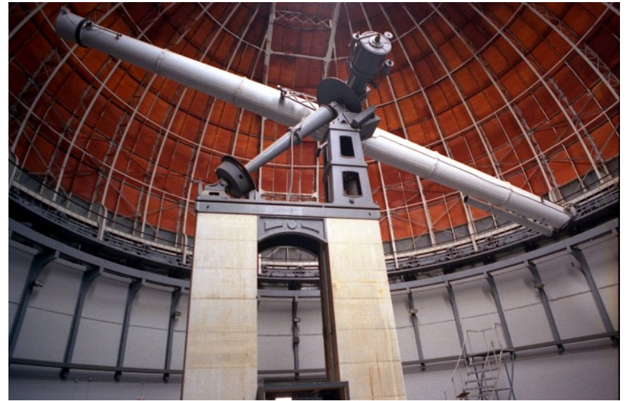
Lunette de l'Observatoire de Nice. Diamètre 760mm, focale 18m.
